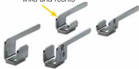
15-2201/39 Platzhalterbolzen, wird in die nicht verwendete Öffnung zur Fixierung der Sägeplattform gesteckt und durch Anziehen von Feststellschraube A fixiert. Dadurch wird ein Auswandern der Schraube nach innen durch die Vibration beim Sägen vermieden.
